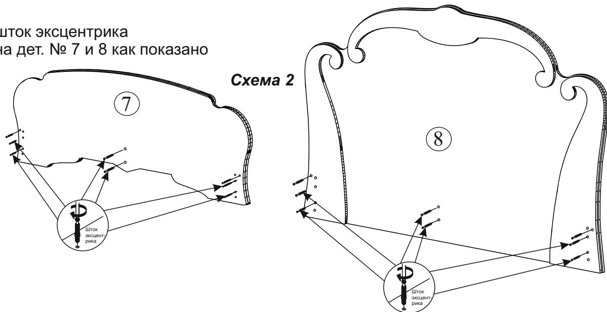
5. Приступите к сборке каркаса. Соедините между собой дет № 2; 3; 4; 5; 7 и 8 при помощи эксцентриковой стяжки и шкантов. Схема 3.
