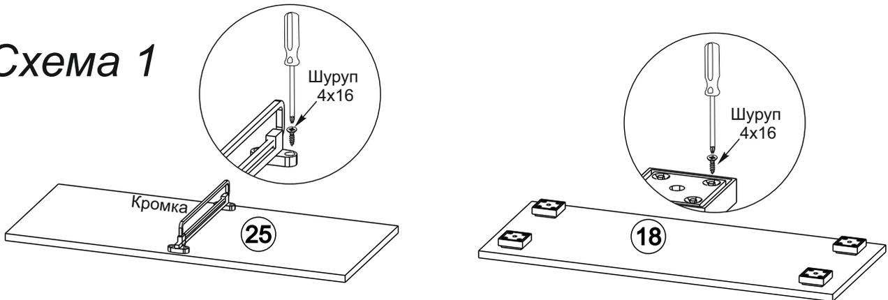
2. Сборка производится горизонтально, тыльной стороной вниз. Предварительно на деталь №18 и деталь №25 закрепите ножки и выдвижную штангу шурупами 4x16 как показано на схеме 1. Далее соедините боковины №8, №9 с вязками №22, №25 и крышками №18, №20 еврошурупами как показано на схеме 2.
