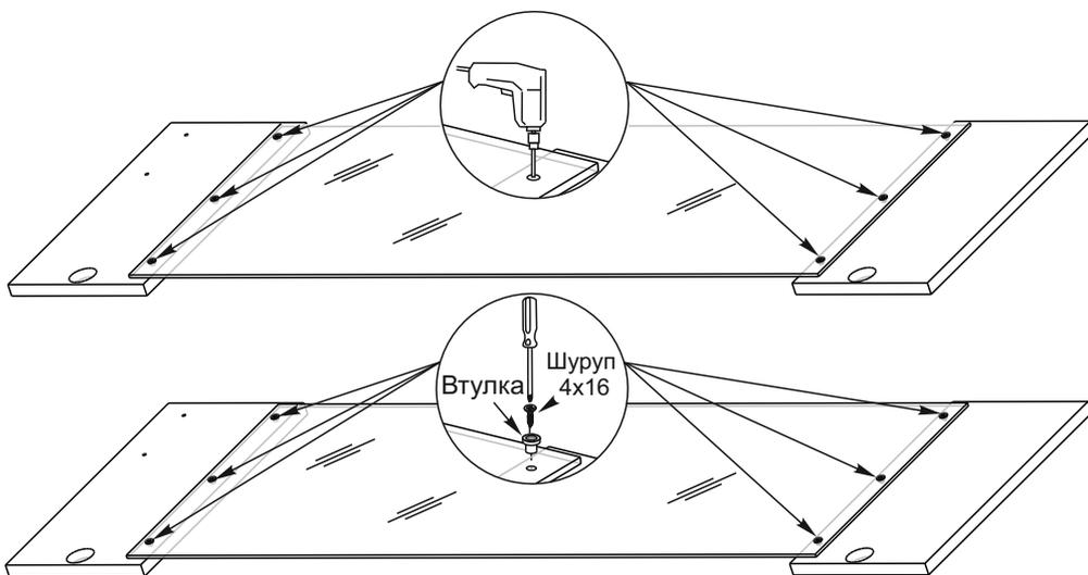
13. После сборки стеклопакета устанавливаем на нее петли с помощью шурупов 4x16 и закрепляем ее на боковине. Устанавливаем ручки и регулируем зазоры, как показано на схеме выше.
