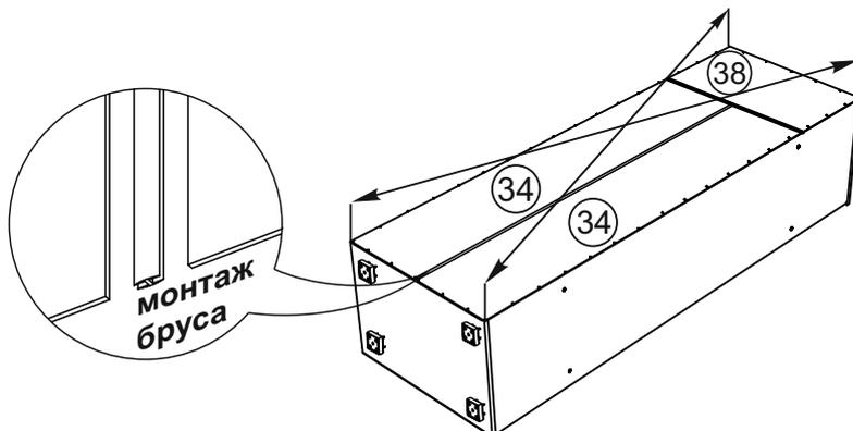
4. На крышку №19 установите опоры с помощью шурупов 4x16. На боковины №10, №11 установите направляющие для ящиков с помощью шурупов 4x16,
