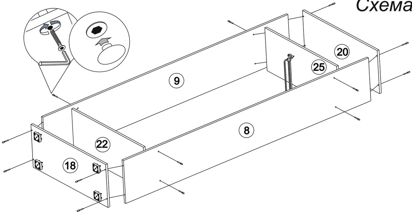
3. Чтобы установить задние стенки №34, №38, необходимо собранную конструкцию перевернуть лицевой стороной вниз. Замерить, с помощью рулетки, и уровнять диагонали и наложить задние стенки соединив их между собой брусом. Аккуратно, не нарушая диагоналей прибить ЛДВП с шагом 130-150мм. гвоздями из комплекта фурнитуры.
