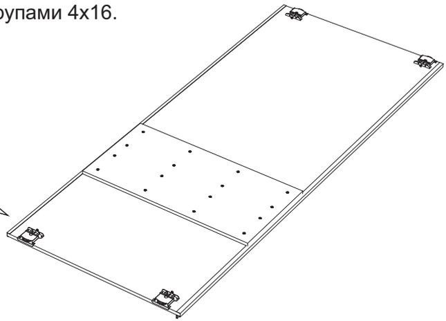
15. Саморезами с потаем 3,5x16 прикрутите к крышке №5 и нижней вязке №6 направляющие с отступом от лицевой части шкафа 27мм.
