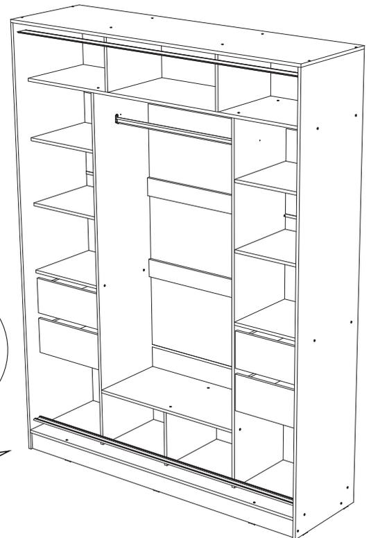
16. Установите фасады в шкаф. Сначала вставьте верхние ролики в направляющую на крышке №5, затем нижние ролики в направляющую на нижней вязке №6. Каждый фасад становится в отдельную канавку (регулировка фасадов по высоте проводится закручиванием или ослаблением регулировочного винта).
