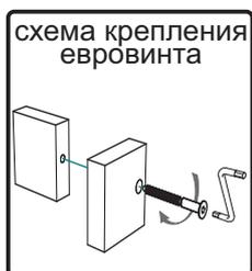
5. Соедините евровинтами планки №9 и вязку №8 с перегородками №3, №4. Вязку №8 соединить с перегородкой №12.
