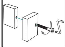
4. Соедините евровинтами перегородки №3, №4 с нижней вязкой №6 и верхней вязкой №7. Также соедините евровинтами перегородки №12 с вязкой №6 и вязкой №7.
