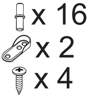
8. На перегородки №3, №4 шурупами 4x16 прикрутите штангодержатели. Установите штангу №28. В боковины №1, №2, перегородки №3, №4 вставьте полкодержатели. Установите полки.
