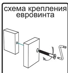
6. Соедините евровинтами вязки №10 с боковинами №1, №2 и перегородками №3, №4. Соедините евровинтами крышку №5 с боковинами №1, №2, перегородками №12.
