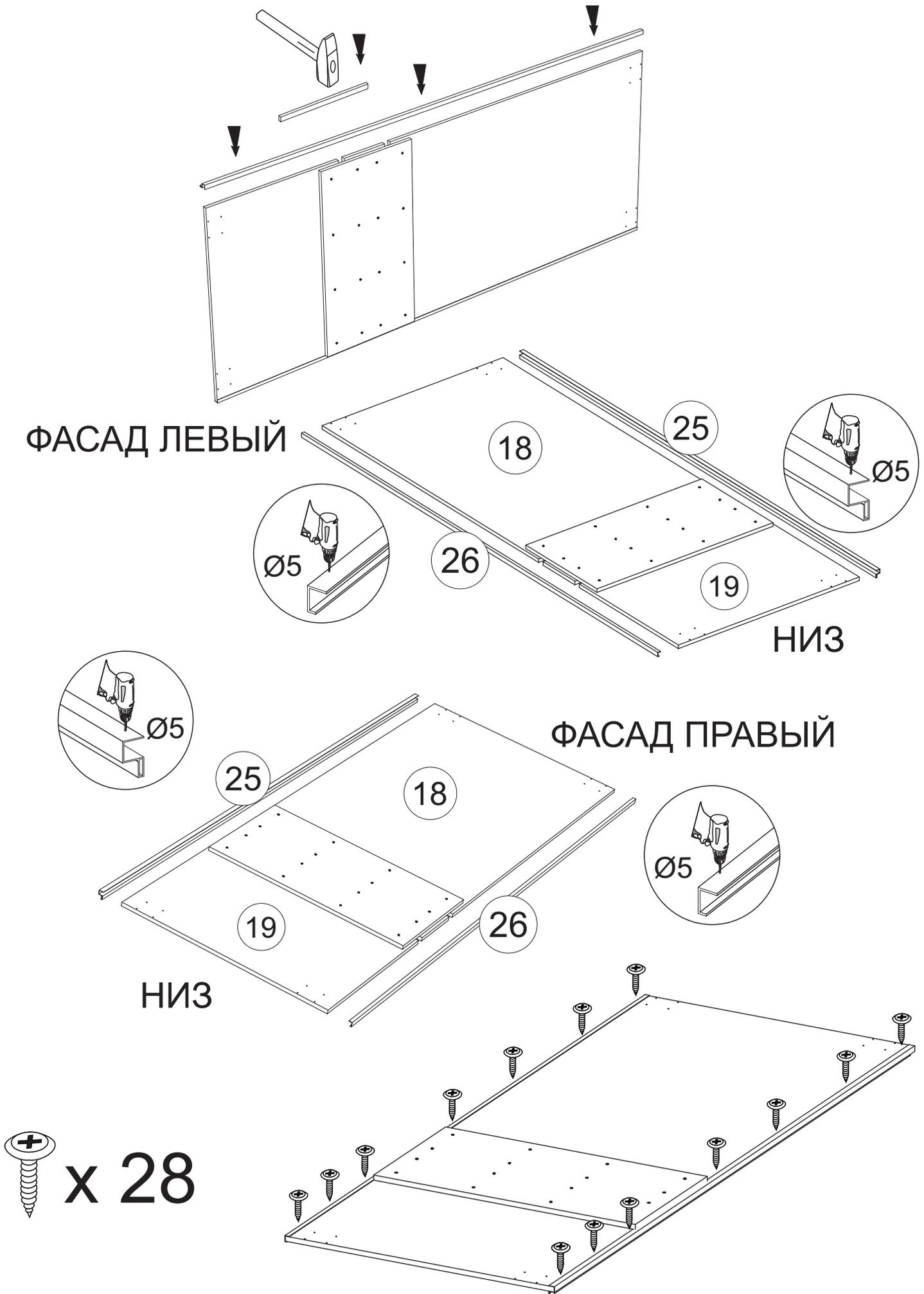
14. Сверху и снизу на фасад закрепите ролики шурупами 4x16.
