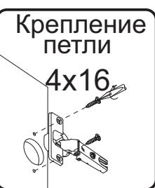
**9.** Навесьте фасад отрегулируйте зазоры. Для крепления ручки, досверлите фасады сверлом Ø5. Ручка крепится винтом 4x20.
