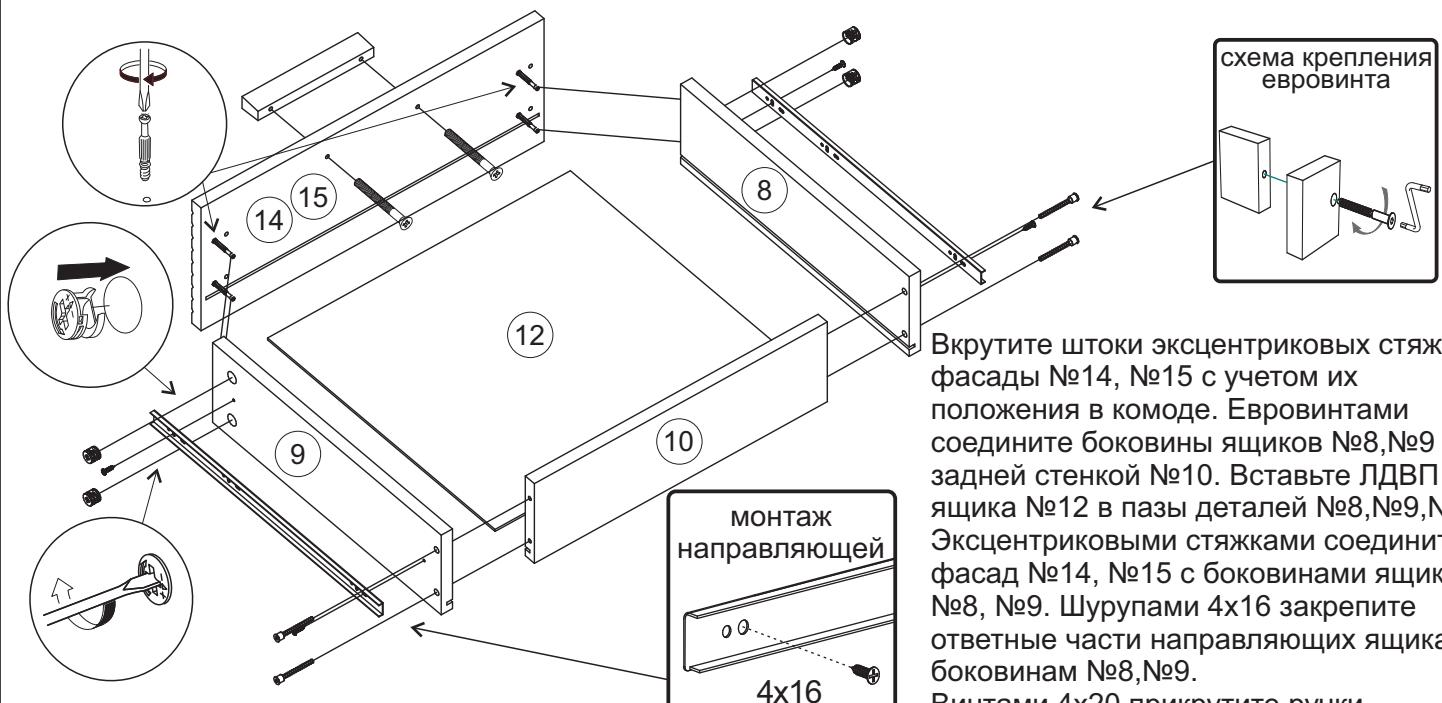
Вкрутите штоки эксцентриковых стяжек в фасады №14, №15 с учетом их положения в комоде. Евровинтами соедините боковины ящиков №8, №9 с задней стенкой №10. Вставьте ЛДВП Дно ящика №12 в пазы деталей №8, №9, №10. Эксцентриковыми стяжками соедините фасад №14, №15 с боковинами ящика №8, №9. Шурупами 4x16 закрепите ответные части направляющих ящика к боковинам №8, №9. Винтами 4x20 прикрутите ручки.
