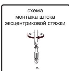
6. Соедините эксцентриковыми стяжками верхнюю крышку №5 с боковинами №1, №2 и перегородками №3, №4.
