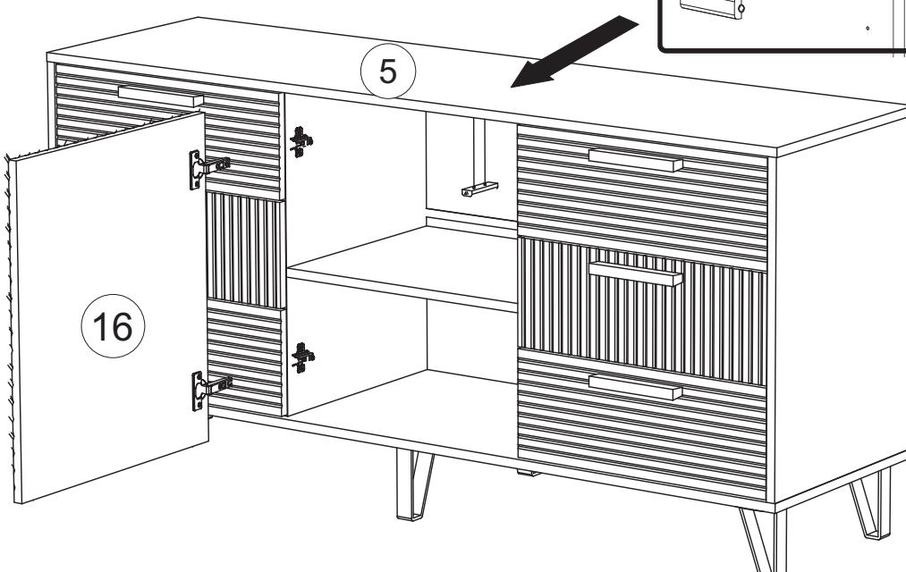
Регулирование зазоров и положения дверей с петлями
