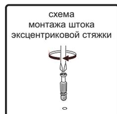
5. Соедините эксцентриковыми стяжками верхнюю крышку №5 с боковинами №1, №2 и перегородками №3, №4.
