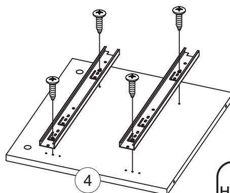
**Схема монтажа, демонтажа направляющих**
