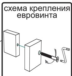
Вкрутите штоки эксцентриковых стяжек в фасады №14, №15 с учетом их положения в тумбе. Евровинтами соедините боковины ящиков №8, №9 с задней стенкой №10. Вставьте ЛДВП Дно ящика №12 в пазы деталей №8, №9, №10. Эксцентриковыми стяжками соедините фасад №14, №15 с боковинами ящика №8, №9. Шурупами 4x16 закрепите ответные части направляющих ящика к боковинам №8, №9. Шурупами 3,5x30 прикрутите ручки.
