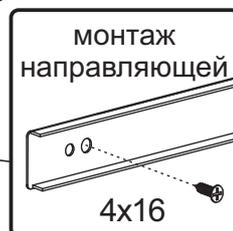
Вкрутите штоки эксцентриковых стяжек в фасад №14. Евровинтами соедините боковины ящиков №15, №16 с задней стенкой №17. Вставьте ЛДВП Дно ящика №19 в пазы деталей №15, №16, №17. Эксцентриковыми стяжками соедините фасад №14 с боковинами ящика №15, №16. Шурупами 4x16 закрепите ответные части направляющих ящика к боковинам №15, №16.
