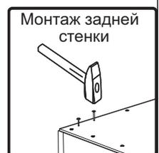
9. Соберите ящики. Евровинтами соедините заднюю стенку ящика №8 с боковинами №6, №7. Боковины №6, №7 соедините с фасадом №31 эксцентриковыми стяжками. Шурупами 4x16 прикрутите к боковинам ящика ответные планки направляющих. Вставьте ЛДВП (дно ящика) №10 в паз фасада №31. ЛДВП закрепите гвоздями 2x20. Досверлите фасад сверлом Ø5. Закрепите ручку винтом, входящим в комплект ручки.
