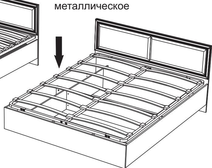
**14. Для кроватей с подъемным механизмом, крепление последнего осуществляется с помощью болтов 6x25, шайб D6, гаек M6.**
