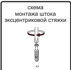
**9.** Соедините эксцентриковыми стяжками царгу №1, №2 с передней перегородкой №4 и средней перегородкой №5.
