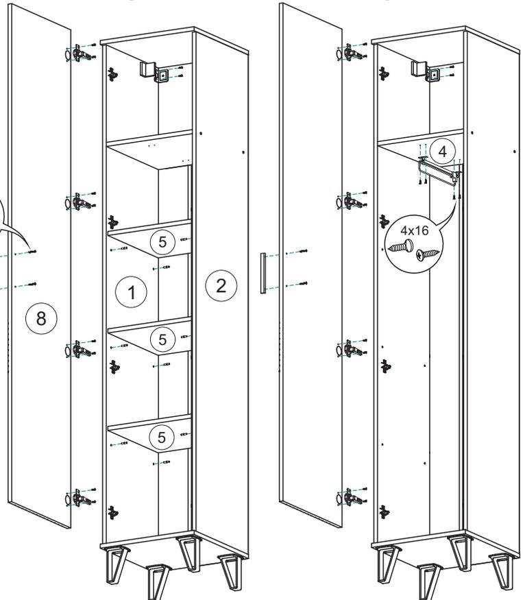
Регулирование зазоров и положения дверей с петлями
