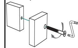
**6.** Шурупами 4x16 закрепите опоры к крышке №3.
