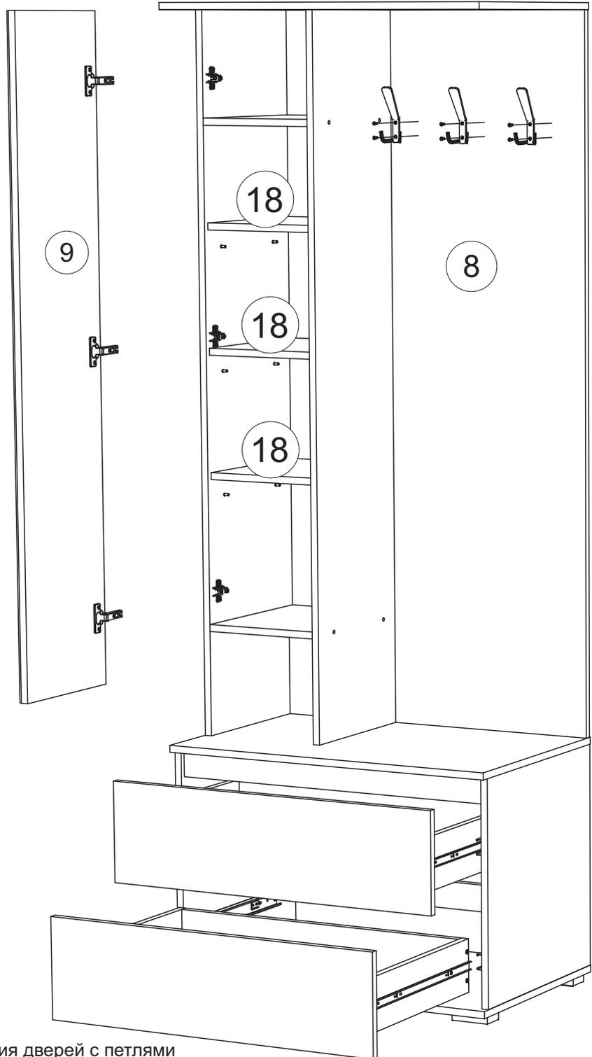
**Регулирование зазоров и положения дверей с петлями**
