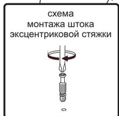
**9.** С помощью эксцентриковых стяжек соедините планки №11 с боковинами №1, №2.
