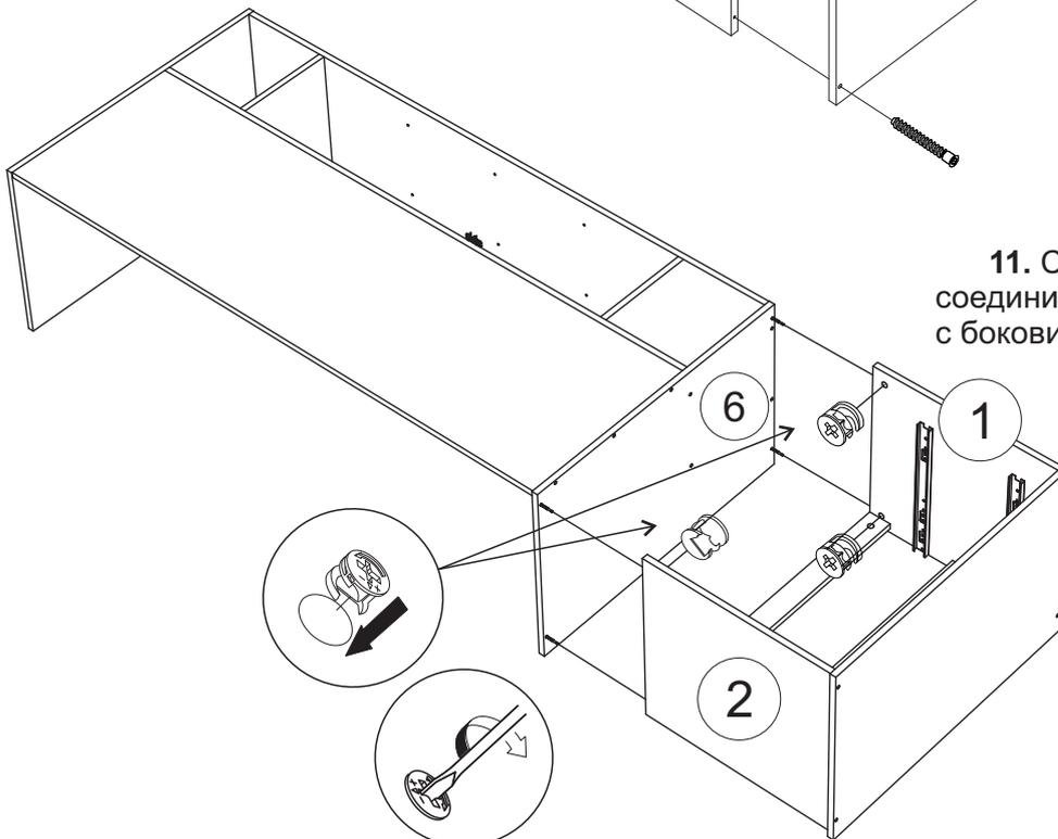
**11.** С помощью эксцентриковых стяжек соедините среднюю крышку №6 с боковинами №1, №2.
