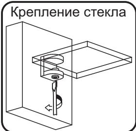
монтаж эксцентриковой стяжки
