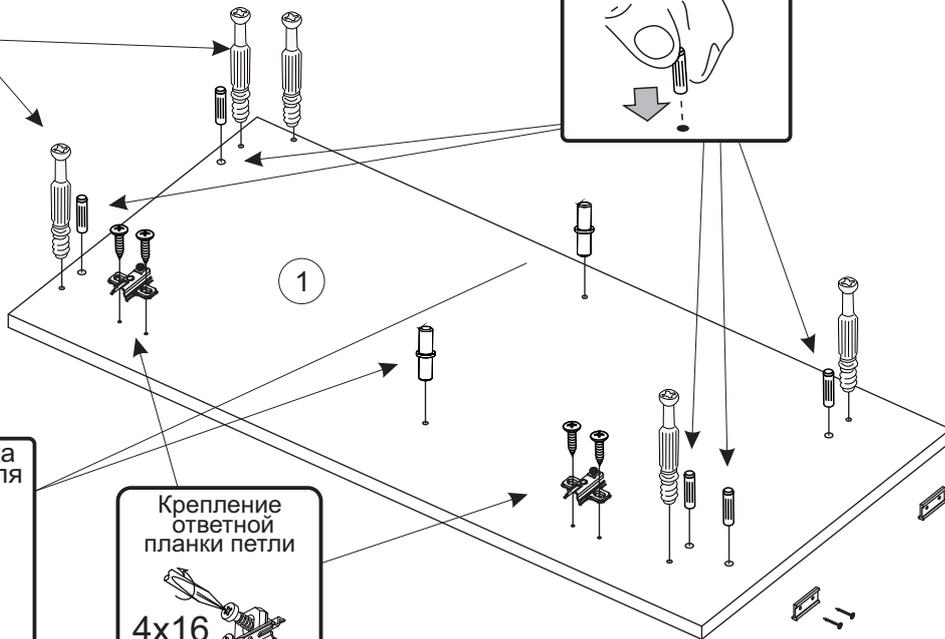
12. Соедините эксцентриковыми стяжками боковины №1, №2 с вязками №5, №6, планкой №7.
