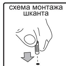
8. Соедините эксцентриковыми стяжками вязку №5 с перегородками №3, №4, а с планками №9 шкантами.
