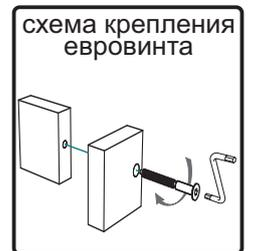
4. Соедините эксцентриковыми стяжками планки №11 с перегородками №3, №4.
