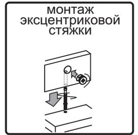
8. Соедините эксцентриковыми стяжками боковину №2 с верхней вязкой №3, верхней планкой №5, планками 6, нижней вязкой №4, а с цоколем №10 шкантом.
