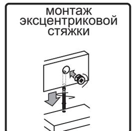
7. Соедините эксцентриковыми стяжками боковину №1 с нижней вязкой №4, а с цоколем №10 шкантом.
