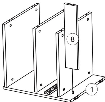
4. Эксцентриковыми стяжками соедините боковину №1 с планкой №4.
