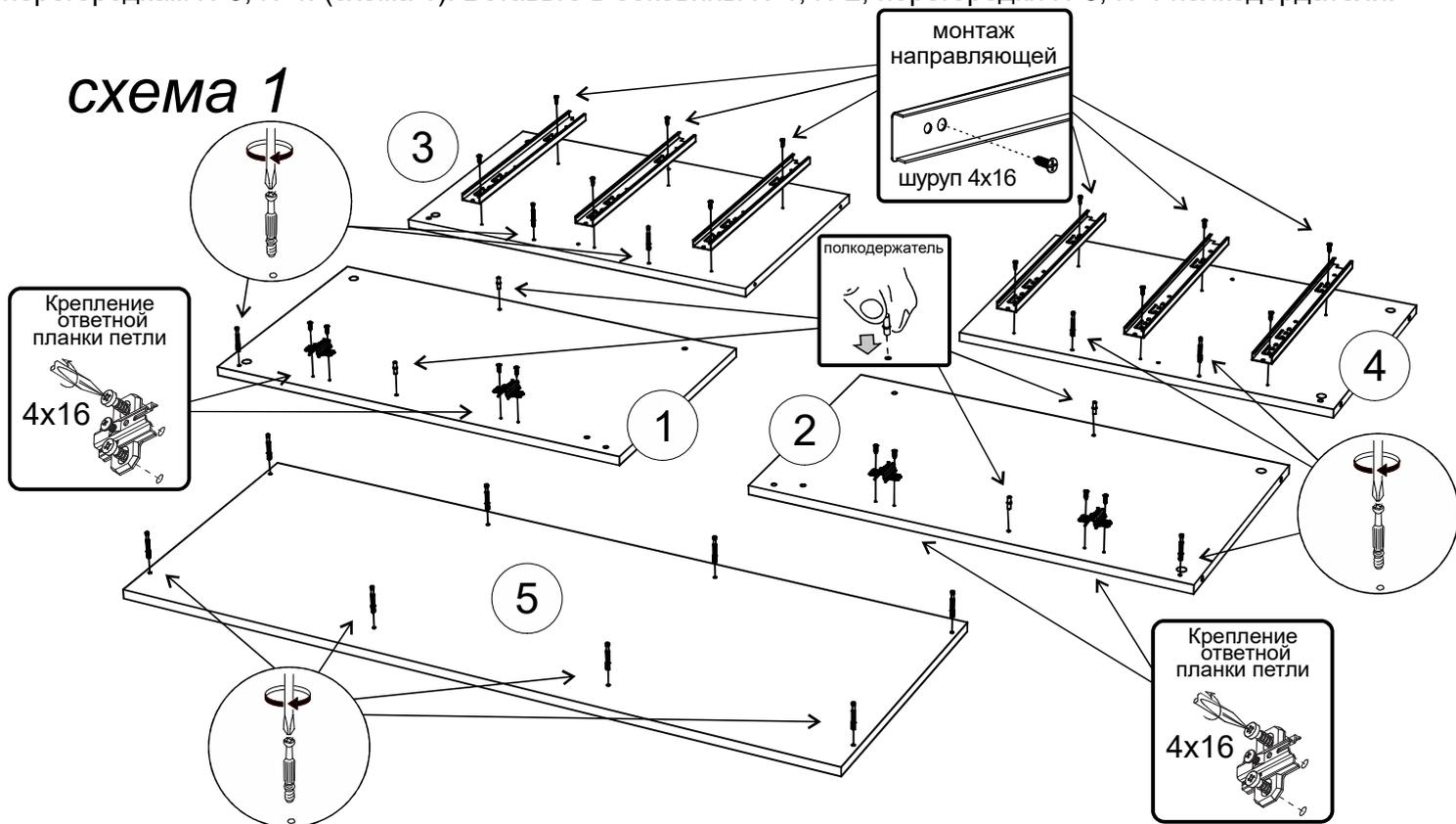
3. Соберите корпус комода. Для этого сначала соедините планки №14 с перегородками №3, №4 (следует закрепить нижнюю и среднюю планку). Затем соедините евровинтами перегородки №3, №4 с вязкой №6. После этого евровинтами закрепите вязку №6 и цоколь №7 к боковинам №1, №2, одновременно соедините эксцентриковыми стяжками верхние планки №14 (к боковинам планка №14 крепится одинарной эксцентриковой стяжкой, к перегородкам двойной). Набейте гвоздями подпятники на боковины №1, №2, цоколь №7. (схема 2).
