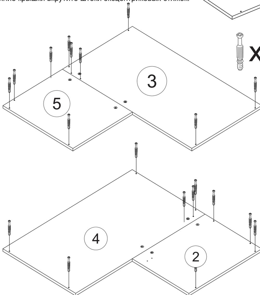
6. Используя эксцентровые стяжки соедините боковины №1 с нижними крышками №3 и №5. Боковины соедините так, чтобы ответные планки петель были смещены к нижним крышкам.
