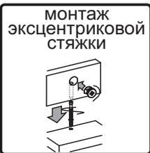
**5. В нижние и верхние крышки вкрутите штоки эксцентриковых стяжек.**
