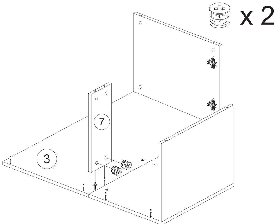
8. Используя эксцентриковые стяжки соедините заднюю стенку №6 с нижними крышками №3 и №5
