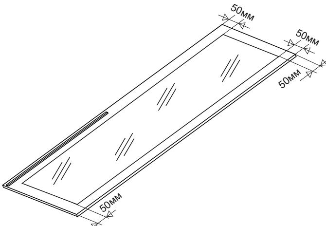
**ИНСТРУКЦИЯ ПО ПОДГОТОВКЕ И МОНТАЖУ ЗЕРКАЛ НА СТВОРКИ**
