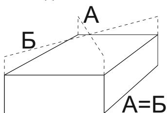
**6.** Шурупами 4x16 закрепите петли к створкам 9,10. *Обратите внимание, что накладные петли устанавливаются на крайние створки, а полунакладные на центральные створки!* Навесьте створки и отрегулируйте зазоры как показано на схеме. Закрепите ручки входящими в комплект винтами. Установите штанги 14,15 и полки 8 (схема 5).
