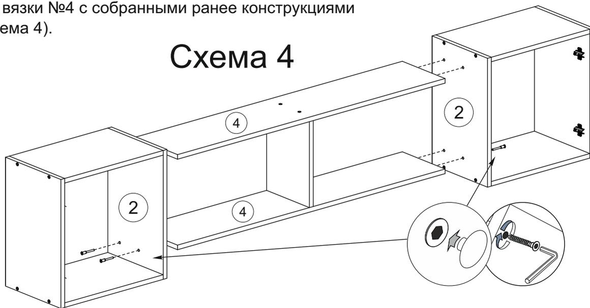
6. Изделие крепится двумя способами: 1 способ - межсекционной стяжкой между соседними модулями (для этого необходимо просверлить отверстия D 5 мм в боковинах 1 и смежных с ними боковинах соседних модулей, затем стянуть модули межсекционной стяжкой).
