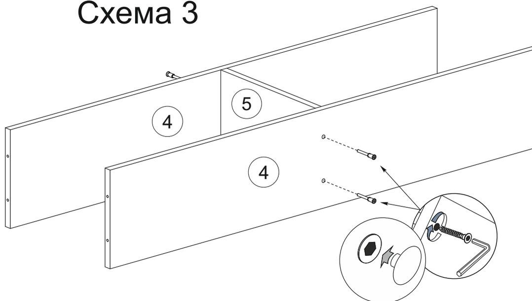
5. Соедините вязки №4 с собранными ранее конструкциями евровинтами (схема 4).
