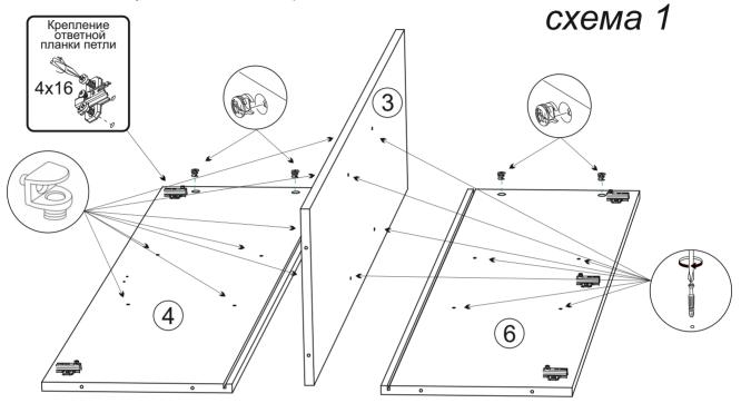
3. Соберите корпус шкафа. Для этого с помощью эксцентриковой стяжки соедините детали 6 и 3 с деталями 2. Затем соедините эксцентриковой стяжкой и шкантами крышку №7 к боковинам №4 и №6 и перегородке №3. Вставьте в пазы задние стенки ДВП №1. Закрепите крышку №5 к боковинам 4,6 и перегородке 3 при помощи эксцентриковых стяжек и шкантов (схема 2).
