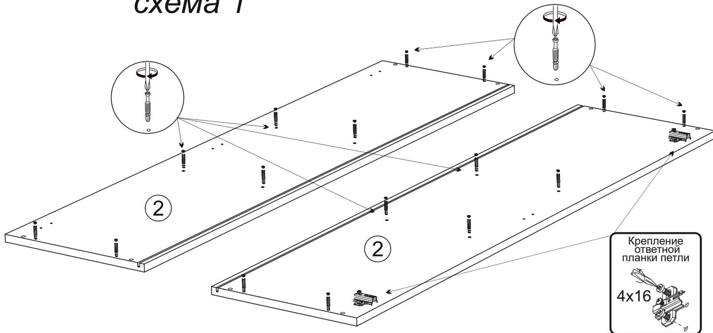
3. Соберите корпус тумбы. Для этого соедините эксцентриковыми стяжками и шкантами боковины №2 и вязки №3, а вязки №4 закрепите на эксцентриковые стяжки. Вставьте в пазы заднюю стенку ЛДВП №1, установите уголки Rv8 и при помощи шурупов 4x16 закрепите их, предварительно проверив диагонали А и Б при помощи рулетки (схема 2).
