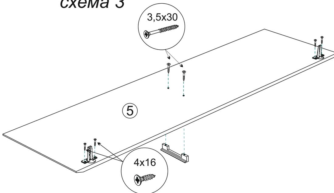
5. Установите навесы на тыльные стороны боковин при помощи шурупов 4x30, Повесьте тумбу на место, прикрутите створку к боковине тумбы, отрегулируйте зазоры, как показано на схеме 4.
