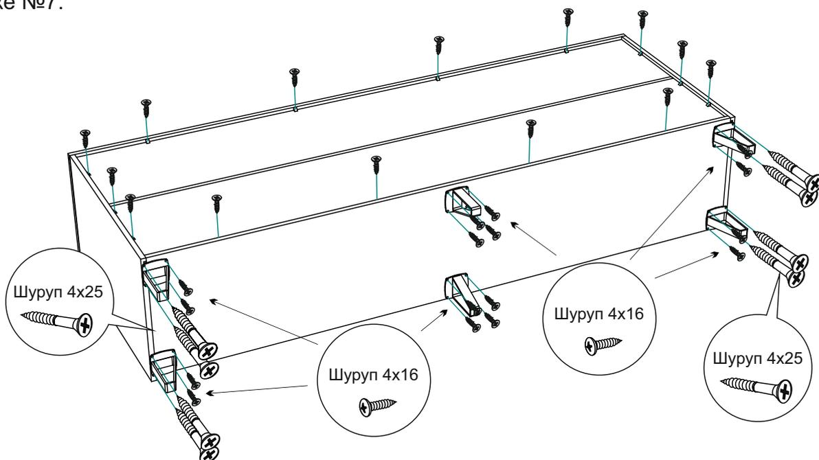
**10.** Опоры по краям установите так, чтобы их одновременно можно было соединить с боковинами №1, №2 и вязкой №7. К боковинам №1, №2 опору следует прикрутить шурупами 4x25, а к вязке №7 шурупами 4x16. Опоры в центре прикрутите шурупами 4x16.
