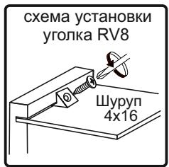
4. Положить панели 7 и 8 горизонтально, лицевой стороной вниз, затем соединить их стеклом 9, используя шурупы 4x16 и втулки для стекла. Закручивание шурупа производить медленно, без усилия, во избежании повреждения стекла.
