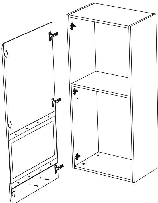
схема монтажа петли
