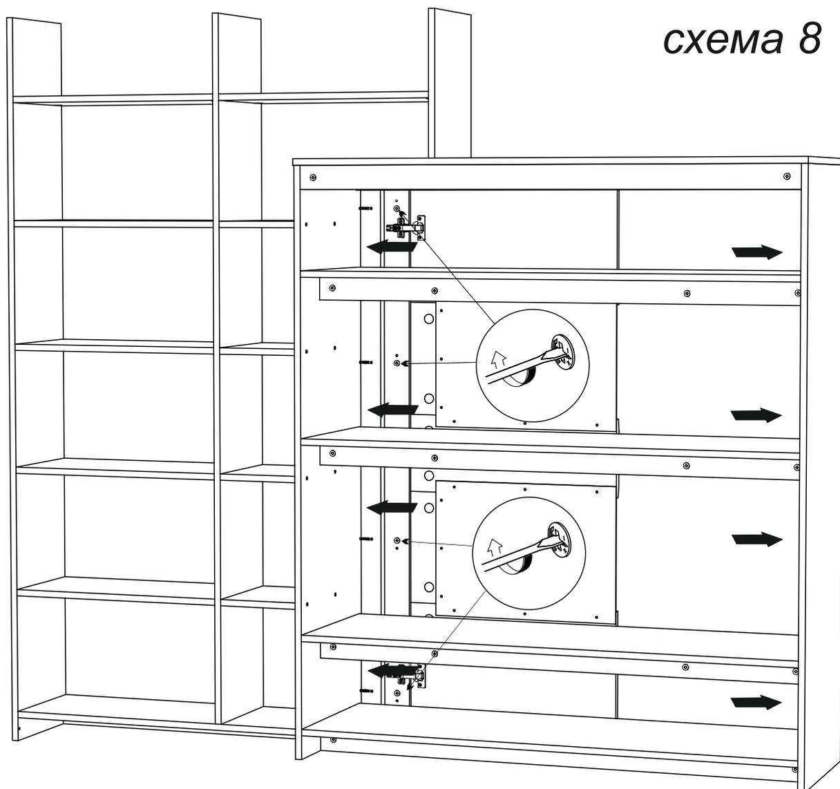
9. Установите шкаф на место и отрегулируйте положение створок согласно схеме приведенной ранее.
