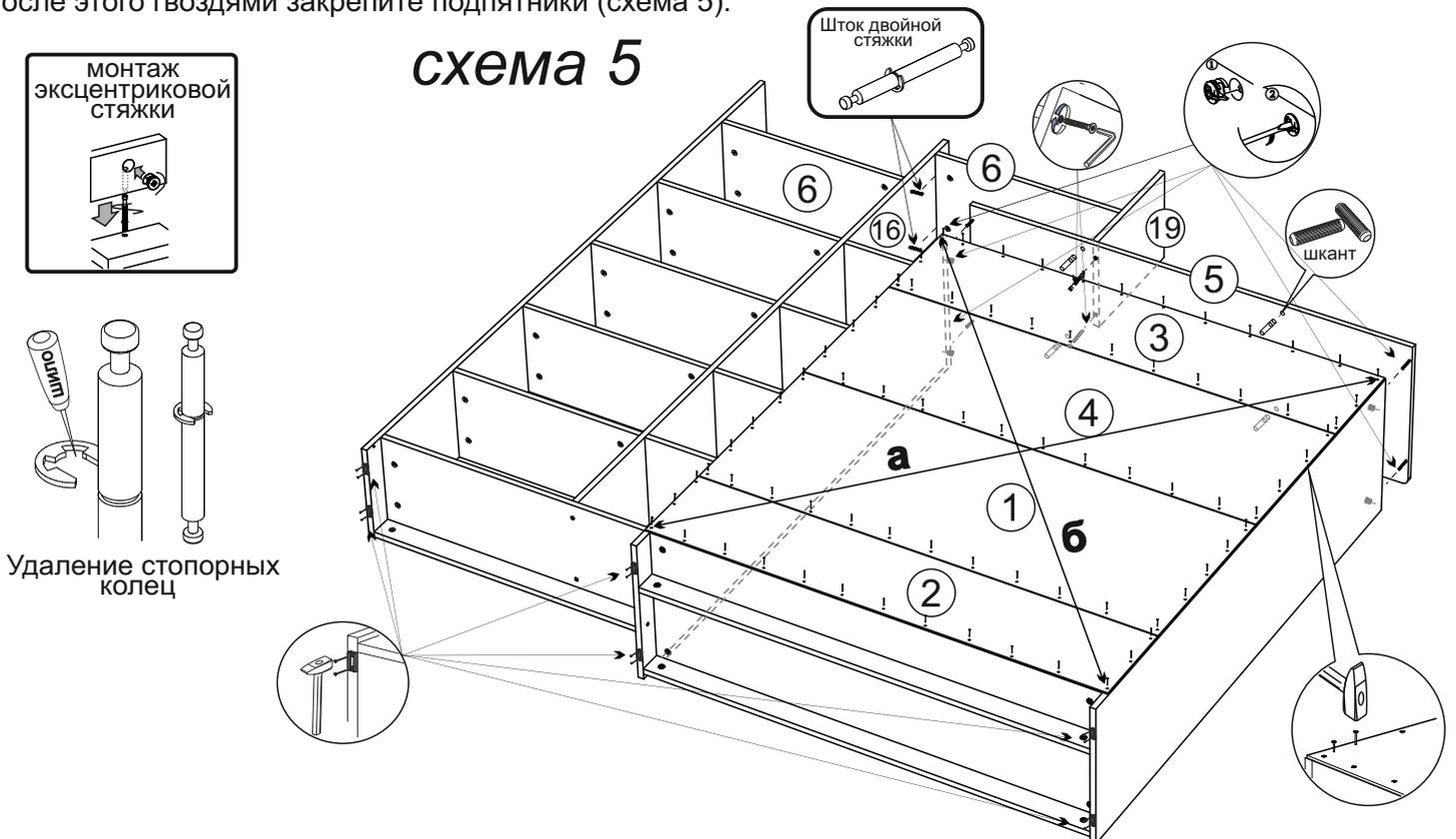
6. Соберите створки. Для этого снимите стопорные кольца с дюбелей. Вставьте их в отверстия на створках №22, №25, №24 и вставке №28, соедините детали и затяните эксцентриковые стяжки. Установите петли при помощи шурупов 4x16 и прикрутите ручки при помощи шурупов 4x45, как показано на схеме 6.
