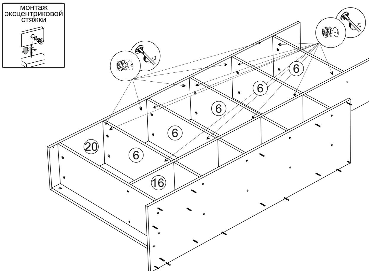
4. Соберите корпус шкафа. Для этого присоедините планки №8 к вязкам №10 при помощи эксцентриков а планки №9 к вязке №15 при помощи шкантов. Затем к боковине №14 присоедините к деталям №8, №9, №10, №15 при помощи эксцентриков. А после этого присоедините к собранной конструкции боковину №12 также на эксцентрики, как показано на схеме 4.
