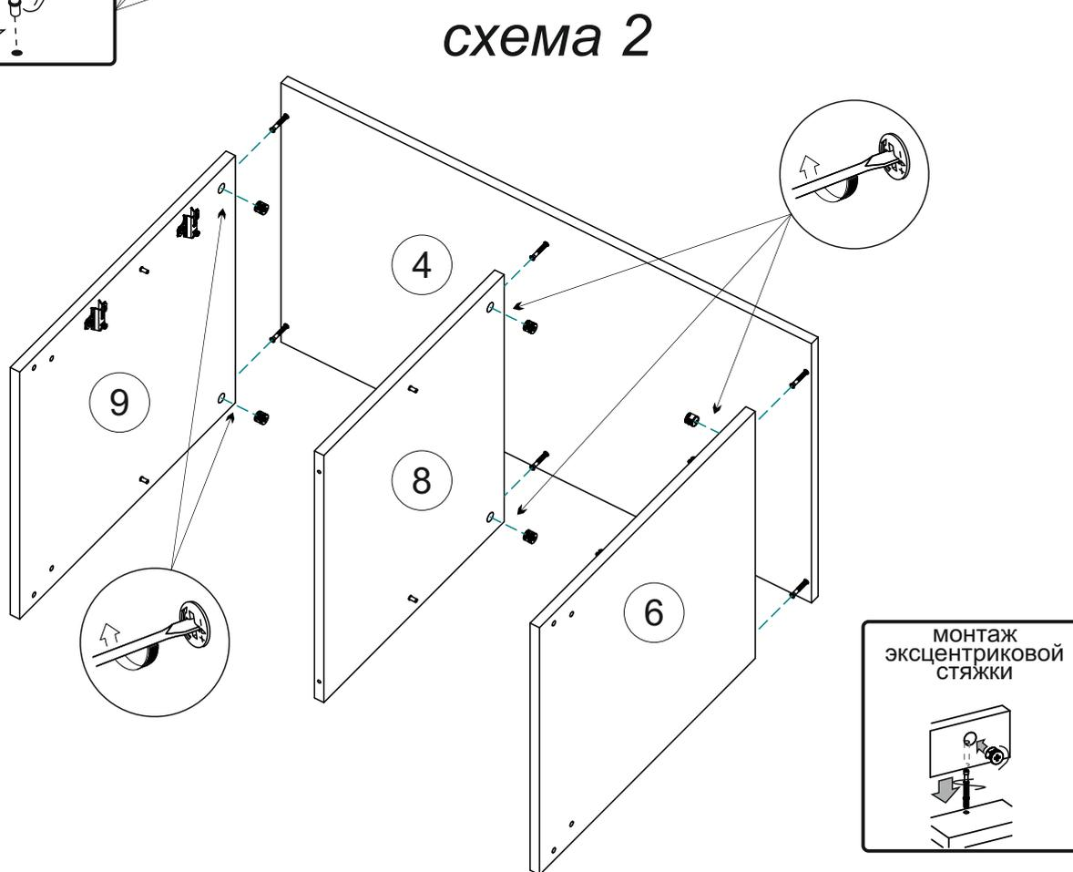
4. Евровинтами закрепите вязку 7 к боковинам 6,9 и перегородке 8. Переверните изделие лицевой стороной вниз. С помощью рулетки уровняйте диагонали А и Б, затем, не нарушая диагоналей, гвоздями закрепите задние стенки (ЛДВП) 1.
