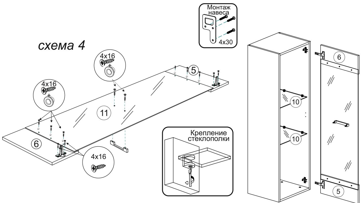
5. Шурупами 4x30 закрепите навесы. Повесьте пенал на место, установите стеклостворку, отрегулируйте зазоры, как показано на схеме выше .
