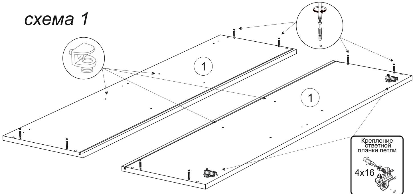
3. Соберите корпус тумбы. Для этого соедините эксцентриковыми стяжками и шкантами боковины №1 и вязки №2. Вставьте в пазы заднюю стенку ДВП №8, установите уголки Rv8 на заднюю стенку №8 при помощи шурупов 4x16, как показано на схеме 2,3.
