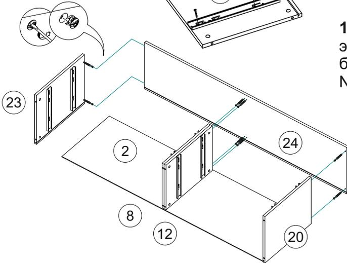
**14.** Затем этими же эксцентриковыми стяжками соедините крышку №22 с боковинами №20, №23, перегородками №8, №12. Зафиксируйте заднюю стенку №2 уголками. Далее шурупами 4x30 прикрутите опоры к крышке №24.
