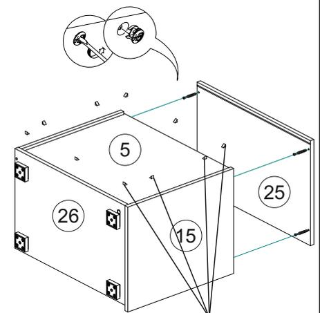
4. Затем этими же эксцентриковыми стяжками соедините крышку №25 с боковинами №11, №15. Зафиксируйте заднюю стенку №5 уголками. Далее шурупами 4x30 прикрутите опоры к крышке №26.
