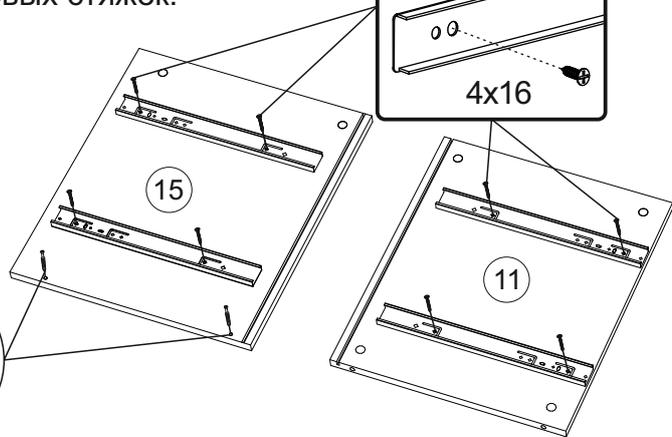
3. Соберите каркас тумбы. Для этого соедините эксцентриковыми стяжками крышку №26 с боковинами №11, №15, вставьте в пазы заднюю стенку №5.
