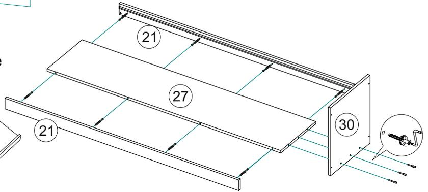
**8.** Соедините обе части тумбы с помощью эксцентриковых стяжек.
