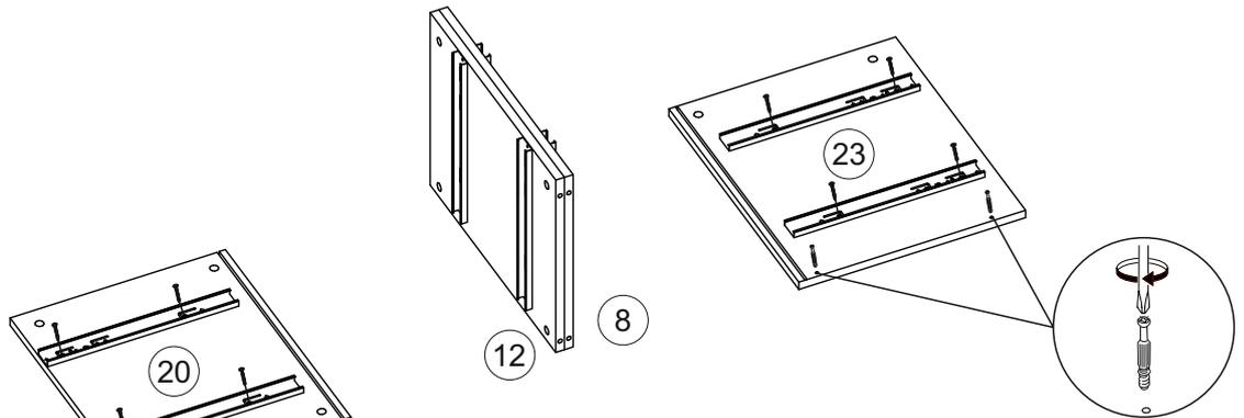
**13.** Соберите каркас тумбы. Для этого соедините эксцентриковыми стяжками крышку №24 с боковинами №20, №23 и с перегородками №8, №12 вставьте в пазы заднюю стенку №2.
