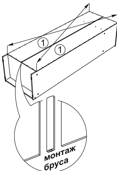
2. Чтобы установить задние стенки (деталь №1), необходимо собранную конструкцию перевернуть лицевой стороной вниз. Замерить с помощью рулетки, и уровнять диагонали. Наложить задние стенки, соединив их бруском. Аккуратно, не нарушая диагоналей, прибить ЛДВП гвоздями, шагом 130-150 мм.
