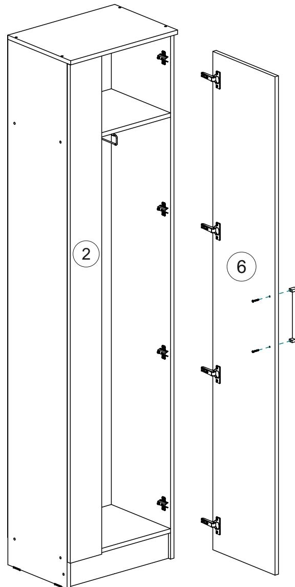
Регулирование зазоров и положения дверей с петлями
