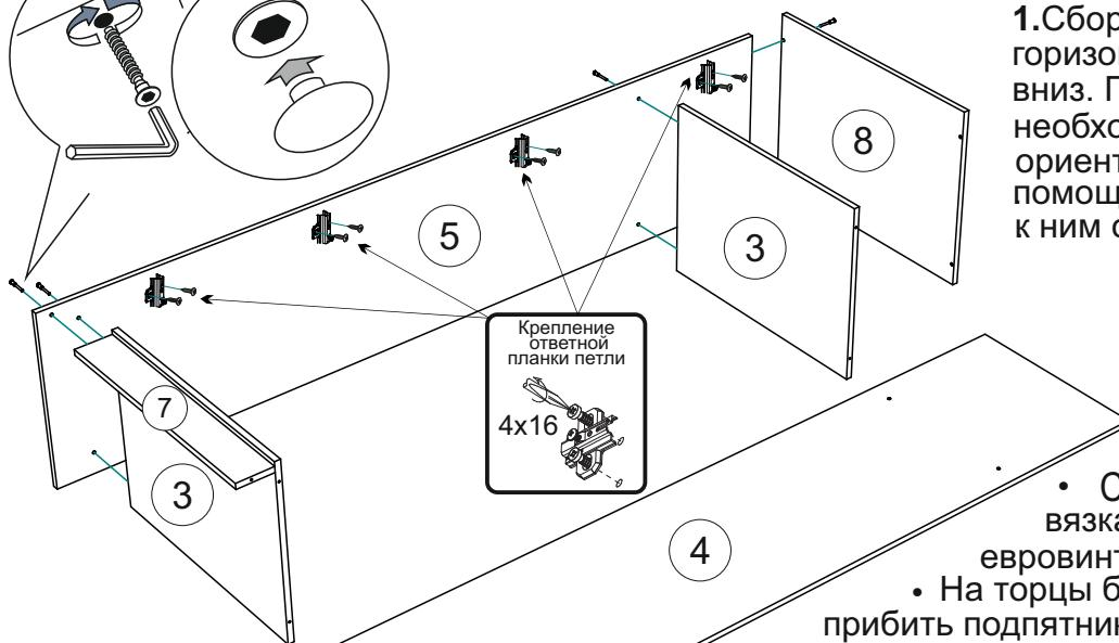
1. Сборка производится горизонтально, тыльной стороной вниз. Предварительно необходимо отобрать боковины 4, 5, ориентируясь на сверловку при помощи саморезов 4x16 привернуть к ним ответные планки петель.
