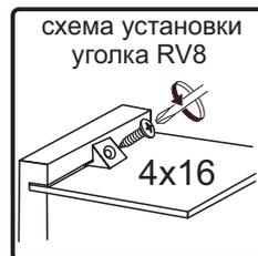
8. Установите опоры так, чтобы их одновременно можно было соединить с боковинами №1, №2 и вязкой №6. К боковинам №1, №2 опоры следует прикрутить шурупами 4x25, а к вязке №6 шурупами 4x16.
