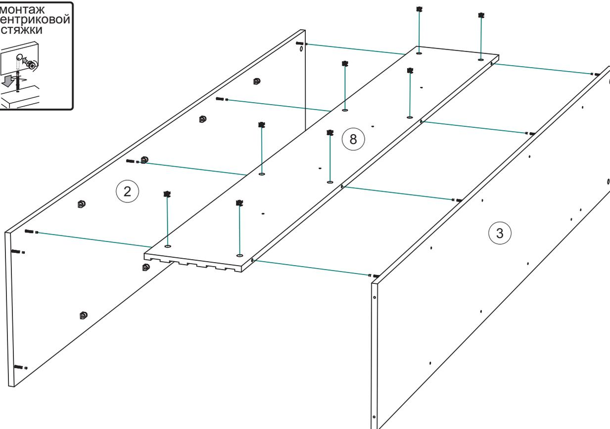
4. Соедините вязку №6 с боковиной №2 эксцентриковой стяжкой, а затем соедините вязку №6 с перегородкой №2 используя евровинты.
