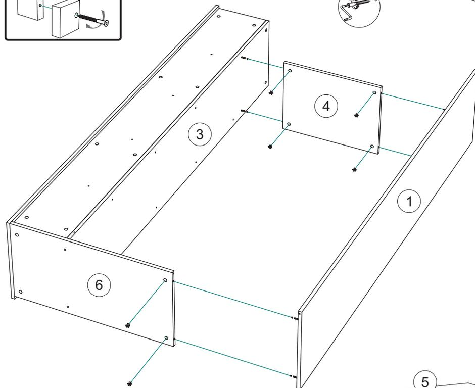
5. Установите левую боковину №1. Для этого эксцентриковыми стяжками соедините вязку №4 с боковиной №1 и перегородкой №4, а также боковину №1 с вязкой №6.
