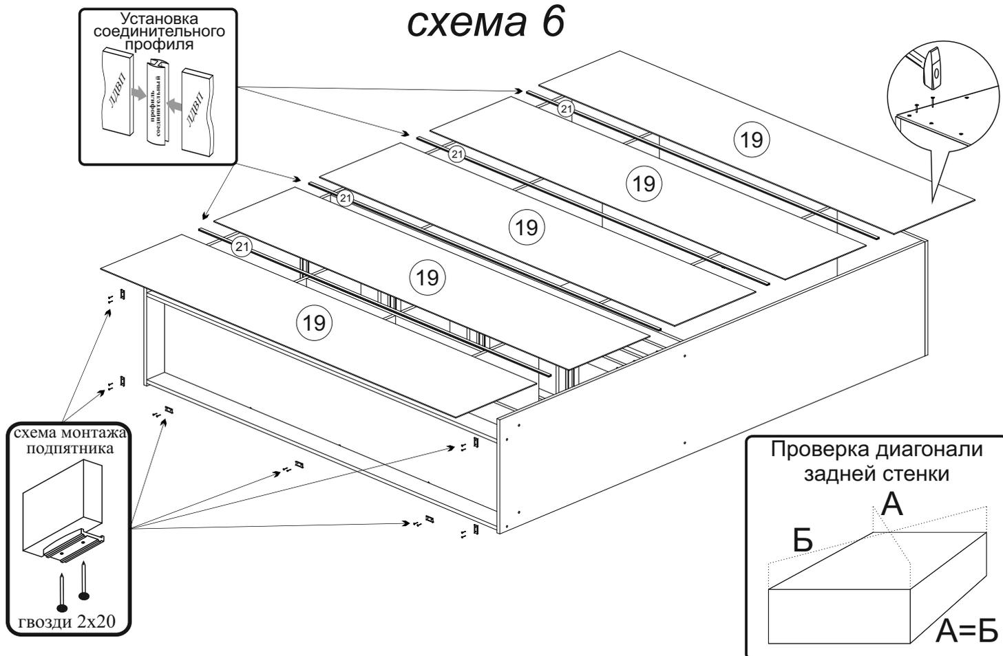
8. Соберите ящики. Вкрутите штоки эксцентриковой стяжки в лицевые панели 15. **Обратите внимание на схему монтажа штоков эксцентриковой стяжки для лицевых панелей 15, размещённую на следующей странице!** Евровинтами скрепите боковины 12,13 с деталями 14(28). Затем вставьте дно ящика 20(24) в пазы деталей 12,13,14(28), после этого эксцентриковой стяжкой скрепите фасады 15 с боковинами 12,13. **Внимание! Детали 28 и 24 используются в средних ящиках, а детали 14 и 20 в крайних!**
