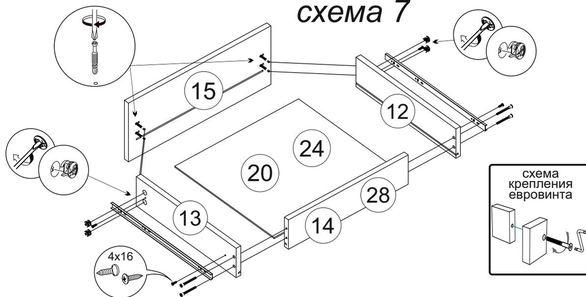
9. Шурупами 4x16 прикрепите петли к створкам 16,17. **Внимание! Накладные петли крепятся на крайние створки, полунакладные на центральные!** Навесьте фасады №16, №17, отрегулируйте их положение по высоте, отрегулируйте зазоры как показано на схеме. Установите ящики на свои места. **Используйте описание для схемы 7 и схему ниже для правильной установки ящиков!**
