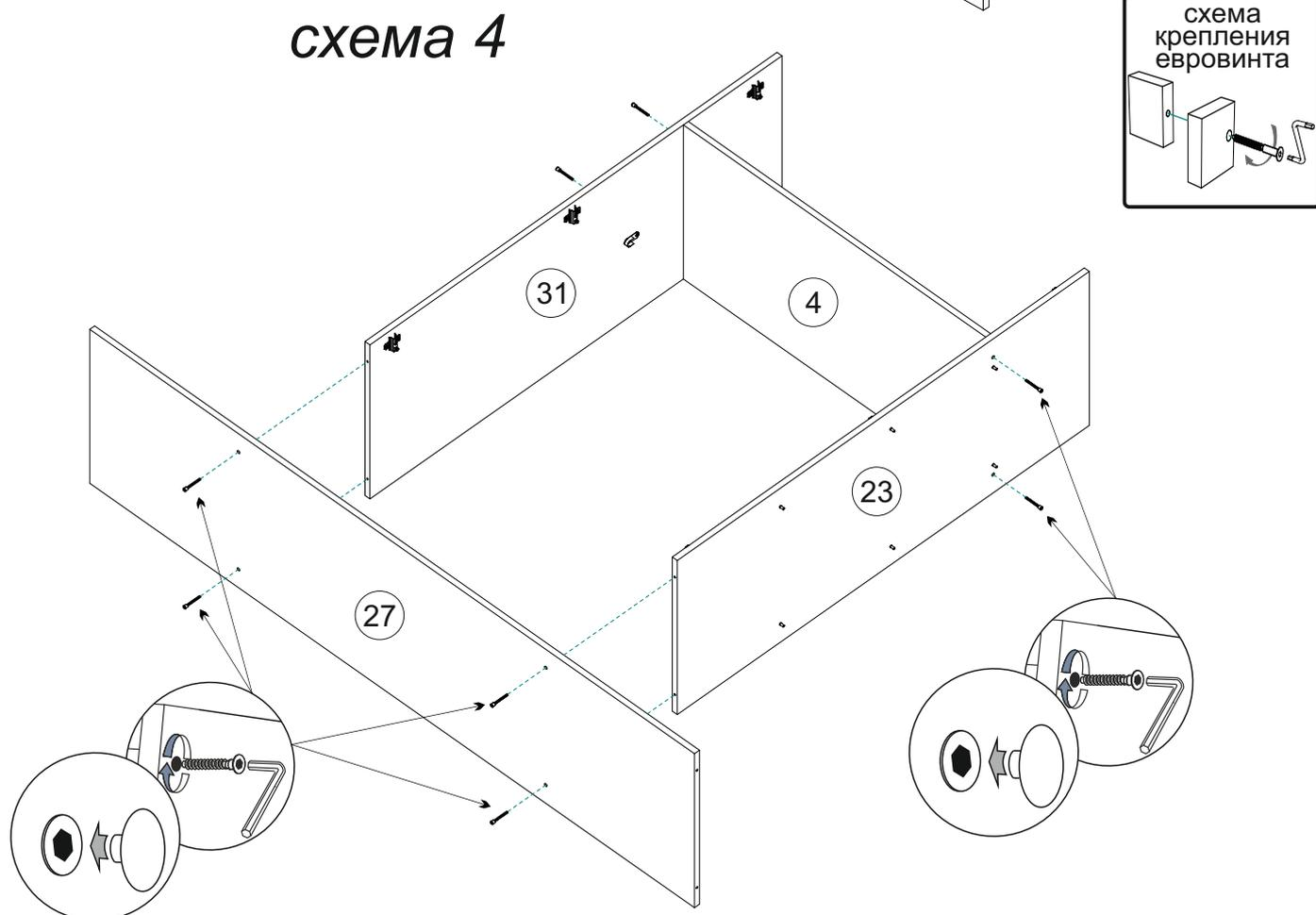
**6.** Соберите корпус шкафа. Сборку проводите лицевой стороной вниз для последующего удобства крепления задних стенок ! Составьте собранную конструкцию со схем 2,3 и 4 вместе, затем с помощью эксцентриковой стяжки скрепите планки 8,9 с боковинами 1,2. Евровинтами прикрепите цоколя 11 к вязке 5, затем эти детали евровинтами соедините с боковинами 1,2. После этого сначала прикрепите евровинтами вязку 27 к боковинам 1,2, затем крышку 3 к деталям 1,2,23,31 (схема 5).
