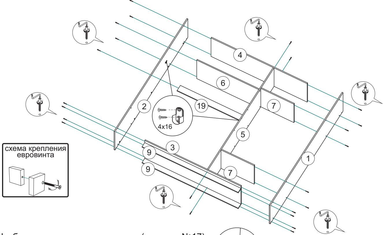
3. Чтобы установить задние стенки (детали №17), необходимо собранную конструкцию перевернуть лицевой стороной вниз. Замерить, с помощью рулетки, и уровнять диагонали ( $a=b$ ). Наложить задние стенки предварительно соединив бруском соединительным и аккуратно, не нарушая диагоналей, прибить ЛДВП гвоздями, с шагом 130-150 мм, затем также гвоздями приейте подпятники на боковины и цоколя.
