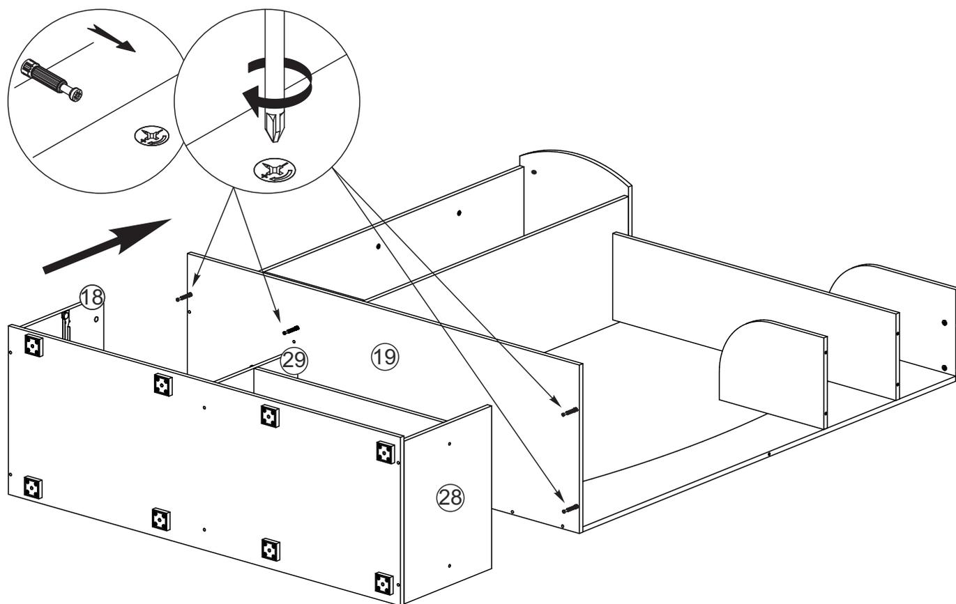
11. Чтобы установить задние стенки №3, №4, №5, необходимо собранную конструкцию перевернуть лицевой стороной вниз, замерить с помощью рулетки, и уровнять диагонали. Наложить задние стенки, аккуратно, не нарушая диагоналей прибить ЛДВП гвоздями с шагом 130-150мм.
