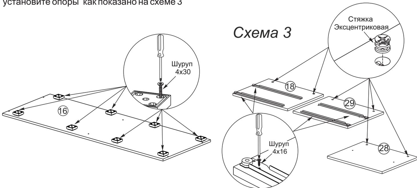
5. Боковины №28, №29 соедините с вязкой №30 евровинтами. Соедините крышку №16 с боковинами №18, №28, №29 евровинтами как показано на схеме 4.
