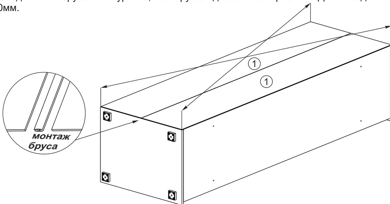
4. На боковины №18, №29 установите направляющие для ящика с помощью шурупов 4x16. На боковины №18, №28, №29 в отверстия установите эксцентриковую стяжку. На крышку №16 установите опоры как показано на схеме 3
