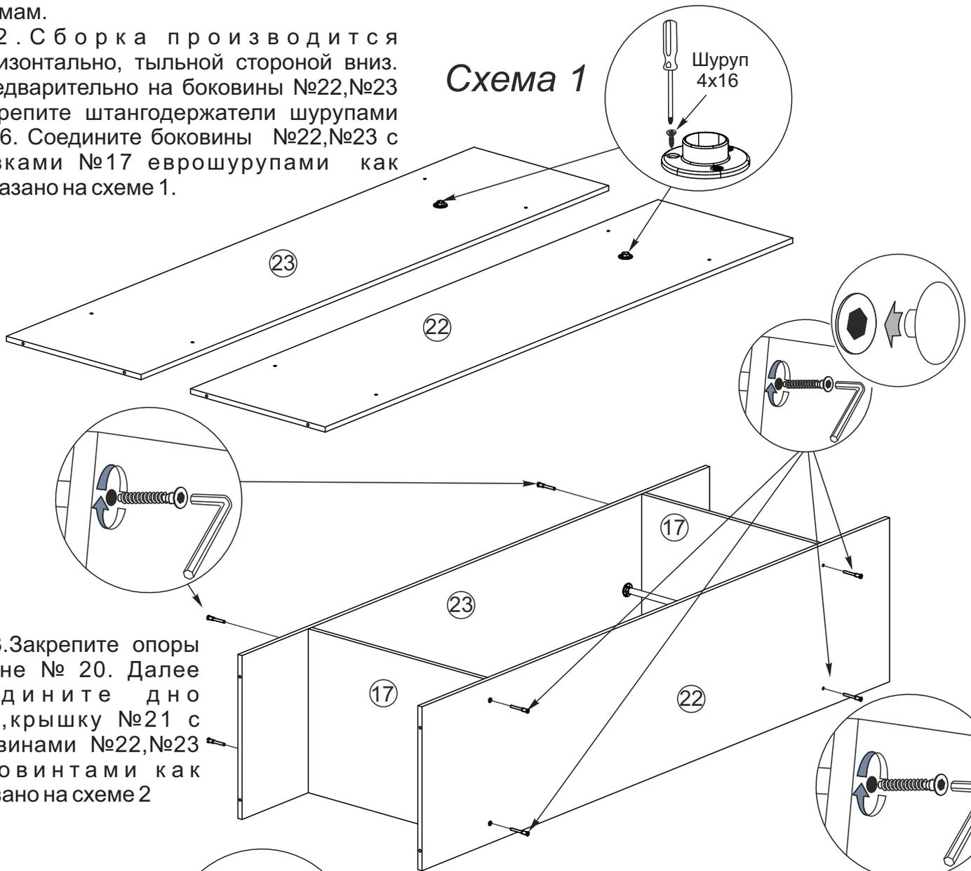
3. Закрепите опоры на дне № 20. Далее соедините дно №20, крышку №21 с боковинами №22, №23 евровинтами как показано на схеме 2
