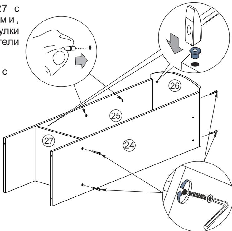
8. Соедините вязку №10 с боковиной №24 евроинтами. На крышке №14 в отверстия установите эксцентриковую стяжку как на схеме 7.
