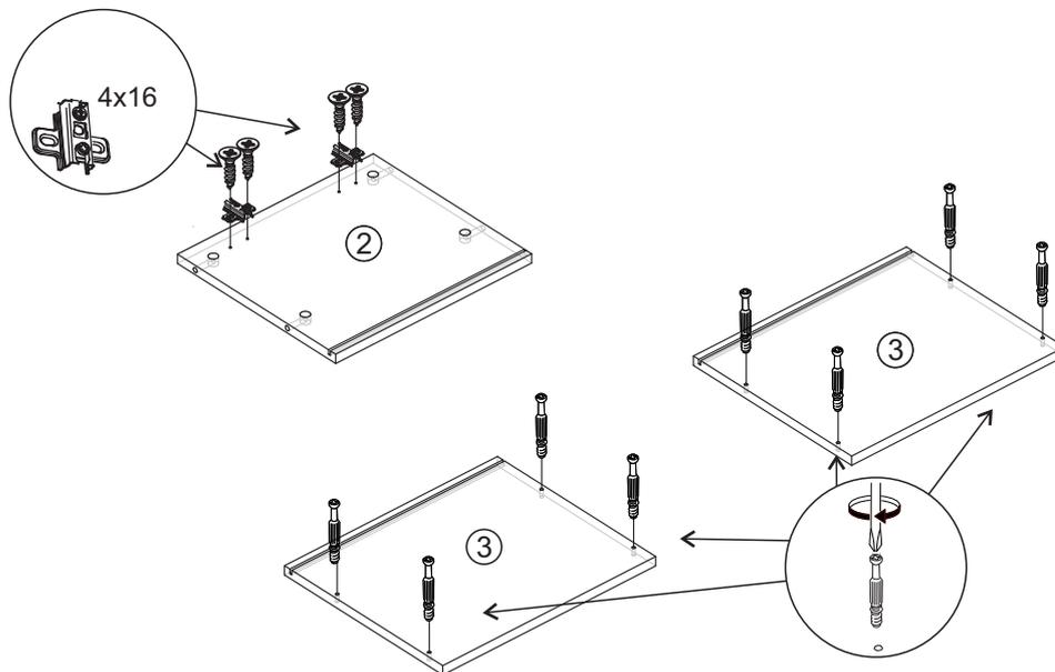
3. Закрепите с помощью эксцентриковых стяжек к нижней крышке №3 боковины №2, затем вставьте в паз заднюю стенку №1 (ЛХДФ) предварительно прорезав отверстия для регулируемых навесов.
