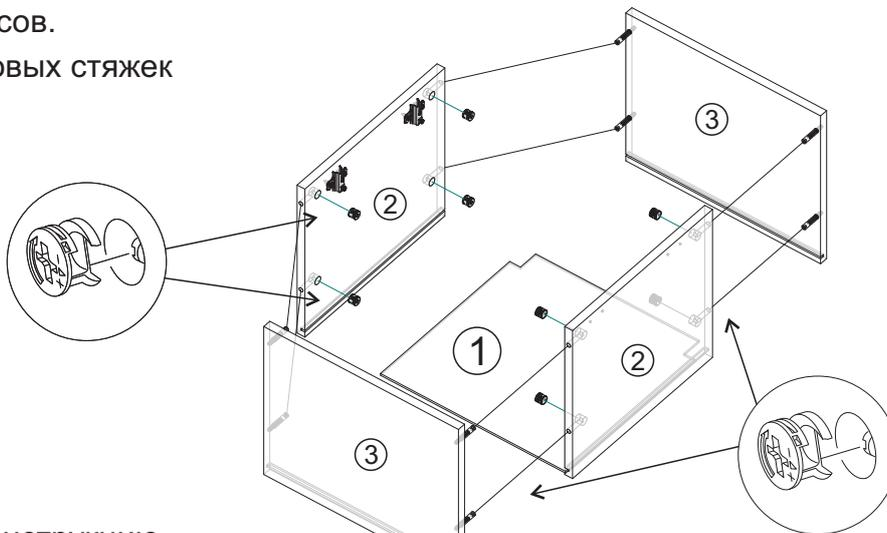
4. Переверните собранную конструкцию лицевой стороной вниз, уровняйте диагонали  $a=b$  и аккуратно не нарушая диагоналей закрепите заднюю стенку №1 к боковинам и крышкам с помощью уголков RV8 и шурупов 4x16.
