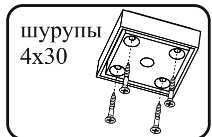
схема монтажа опоры
