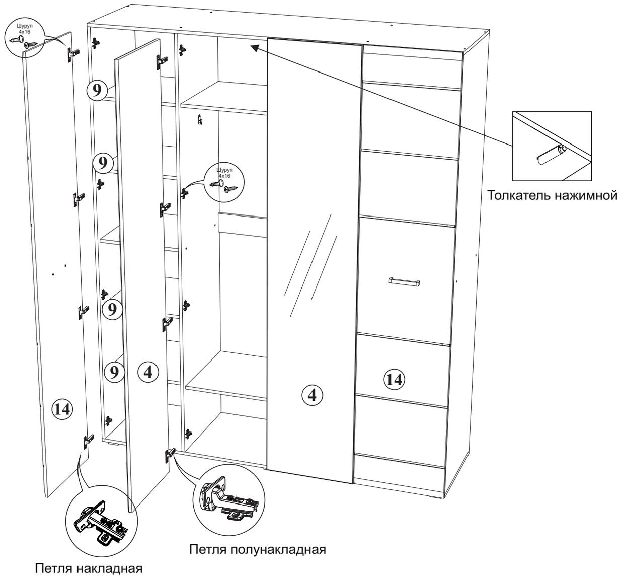
7. Закрепить ответные планки петель к боковинам и перегородкам шурупами 4x16. Закрепить петли на створки 14 и 4, используя шурупы 4x16, согласно инструкции.
