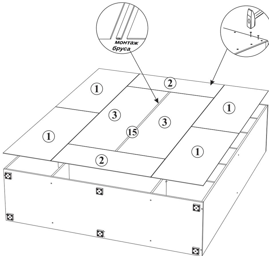
6. Для закрепления задней стенки изделие необходимо разместить горизонтально, лицевой стороной вниз. Закрепить панели 1, 2, 3 гвоздями, предварительно выровняв диагональ при помощи рулетки, и соединив панели 3 профилем 15. В местах соединения панелей использовать пластиковые шайбы для более надежного крепления.
