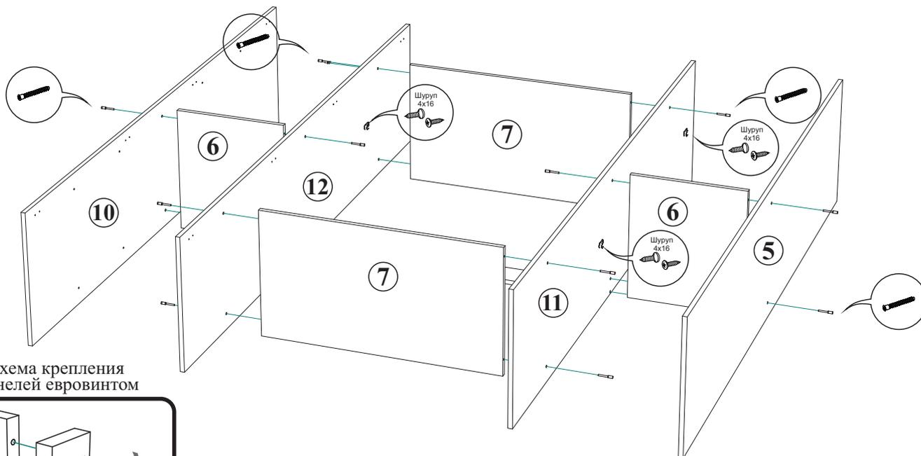
схема крепления панелей евроинтом
