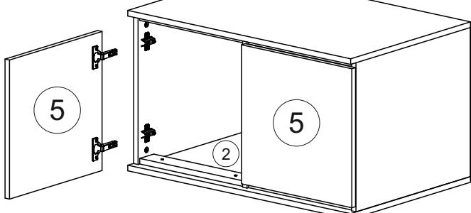
Регулирование зазоров и положения дверей с петлями
