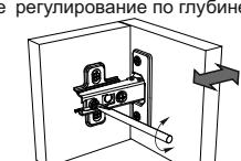
Регулирование зазоров и положения дверей с петлями
