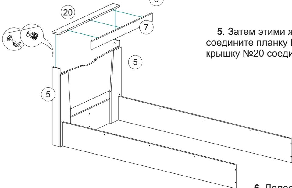
**6. Далее соедините эксцентриковыми стяжками заднюю стенку № 11 с крышкой №20.**
