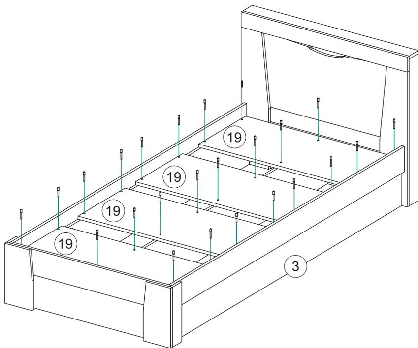
**10.** После сборки каркаса кровати, для придания конструкции жесткости, соедините между собой царги №3, перегородку №4 с настилом №19 евровинтами, как показано на схеме.
