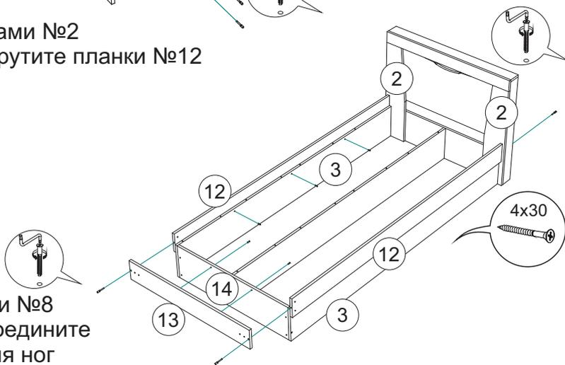
**9.** Эксцентриковыми стяжками соедините ноги №8 с ногами №9. Затем, используя шурупы 4x30, соедините планки №15 с ногами №9. Собранные основания ног прикрутите шурупами 4x30 щиту №14, планкам №12, №13.
