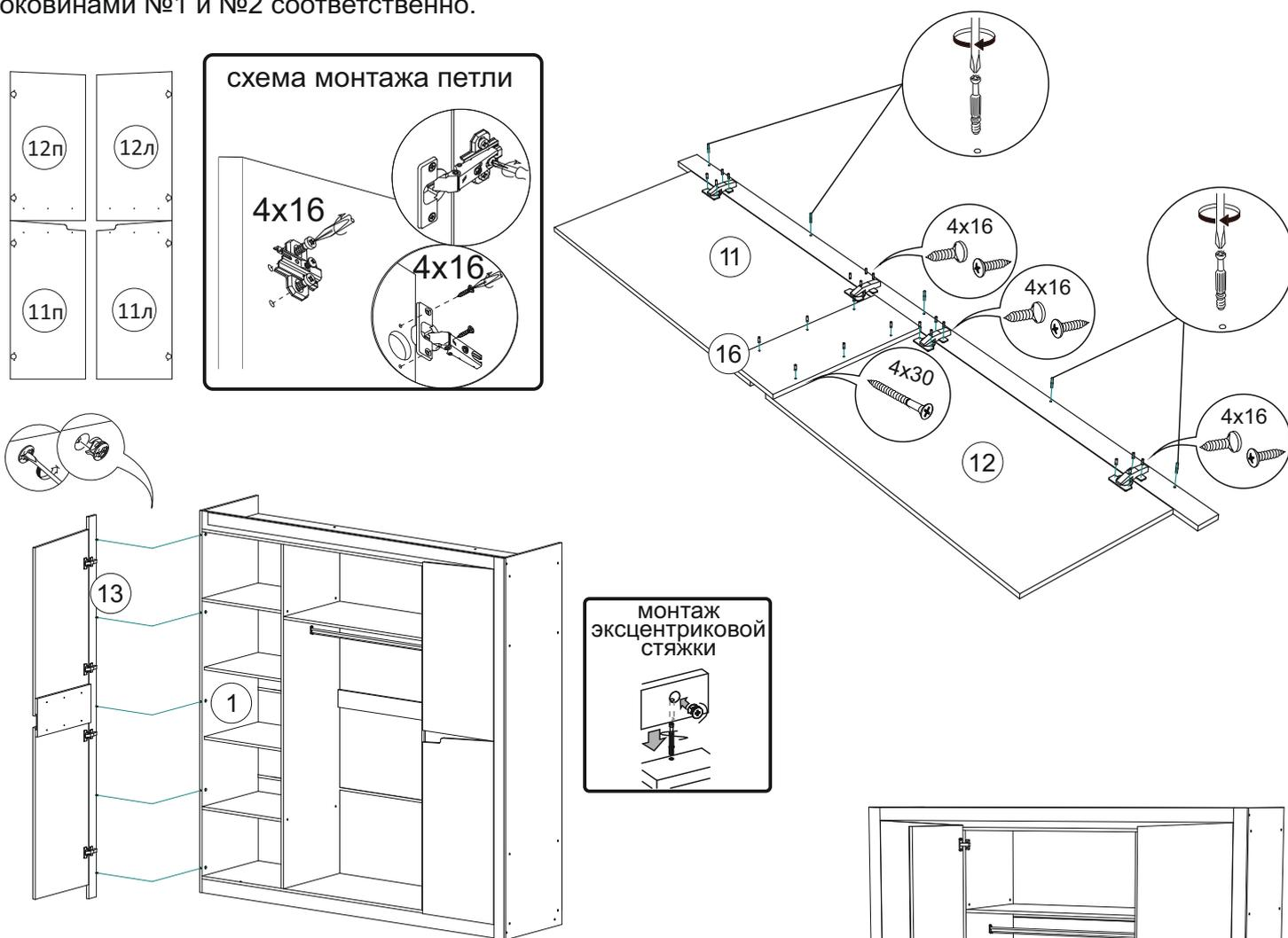
**6.** Используя накладные петли и шурупы 4x16 установите фасады №10 соединив их с перегородками №5. К вязке № 6 прикрутите нажимные толкатели.
