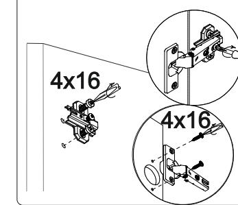
Регулирование зазоров и положения дверей с петлями
